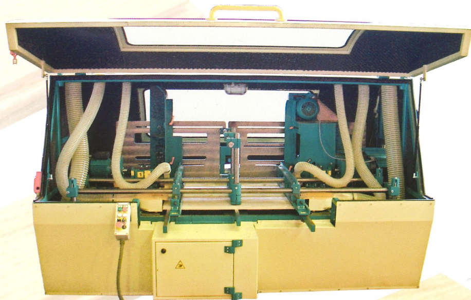
PC 6V 1200 Двухсторонний обрабатывающий и торцовочный станок до 1.200 мм. Two sided tenoning and cross cutting machine up to 1.200 mm.
