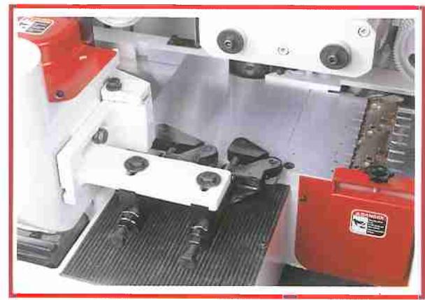
Pressori laterali per terzo mandrino Aiutano il traino dei pezzi stretti e irregolari.
