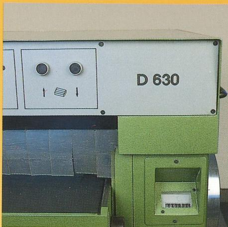
Die **Tischhöhenverstellung** erfolgt automatisch über Drucktaster am Bedienpult.
