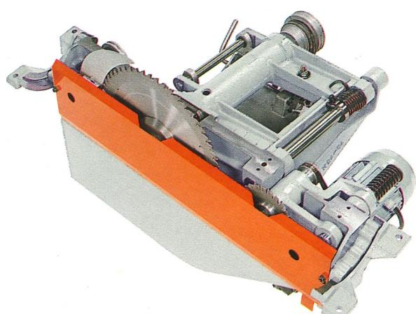
La meccanica interna è un esempio di solidità ed ottimizzazione delle funzioni dei singoli componenti. Cuscinetti a sfera montati a grande distanza entro il supporto dell'albero, ne garantiscono un perfetto bilanciamento. La puleggia condotta, montata all'esterno del gruppo sega, assicura un rapido posizionamento delle cinghie per la scelta di una delle tre possibili velocità di rotazione.
