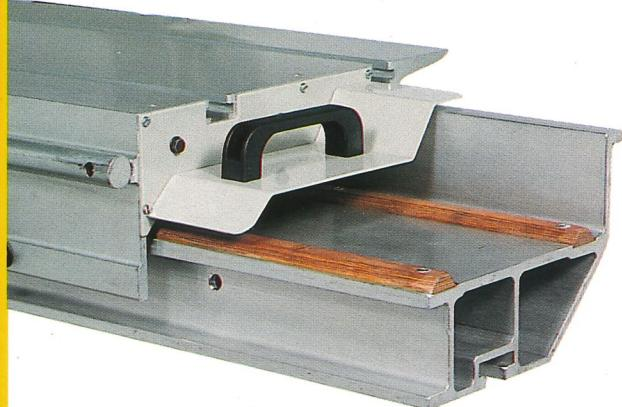
Il carrello in lega di alluminio ha imponenti dimensioni con elevata sezione resistente a torsione e flessione. L'alto grado di finitura con sistema di guida verticale a doppia carrucola garantisce prestazioni tuttora ineguagliate per la massima facilità e l'elevata precisione costanti nel tempo. Le guide di scorrimento in rexilon, refrattarie alla polvere, facilitano la pulizia e riducono la manutenzione.
