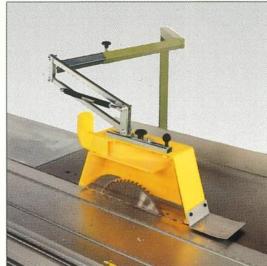
Carrello ausiliario inclinabile. Permette di avere un largo appoggio per inclinazioni sul piano tra 0° e 45° ottenibili con un sistema di bloccaggio rapido.
