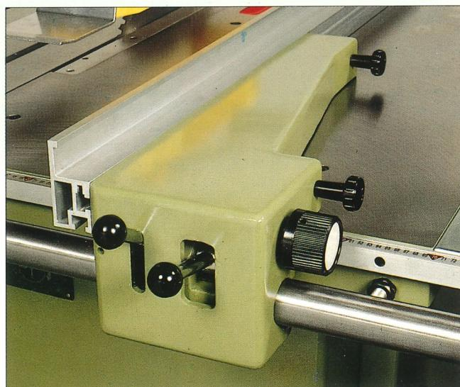
Il carrello ausiliaro é montato su un robusto braccio telescopico e può essere fissato rigidamente al carrello scorrevole in qualsiasi punto. La guida di riferimento, é dotata di grandi fermi ribaltabili. La particolarità di questa guida é quella di poter essere posizionata facilmente su entrambi i lati del carrello ausiliaro essendo i fermi completamente ribaltabili, senza nessun ulteriore spostamento.
