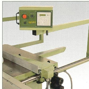
Squadra per tagli paralleli programmabile. Controllata dal programmatore montato sul pensile ha la possibilità di posizionamenti in 'assoluto' per tagli singoli ed 'incrementali' per una sequenza di tagli.
