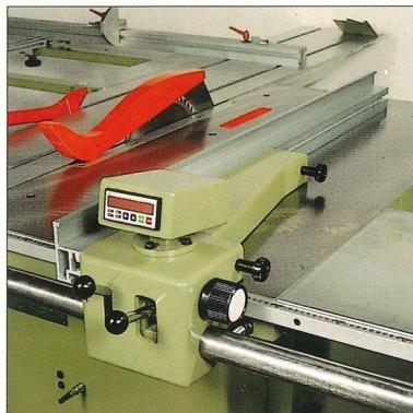
Squadra per tagli paralleli con visualizzatore elettronico. Sistema di lettura rapido e preciso rilevato da un trasduttore che legge su una cremagliera di precisione.
