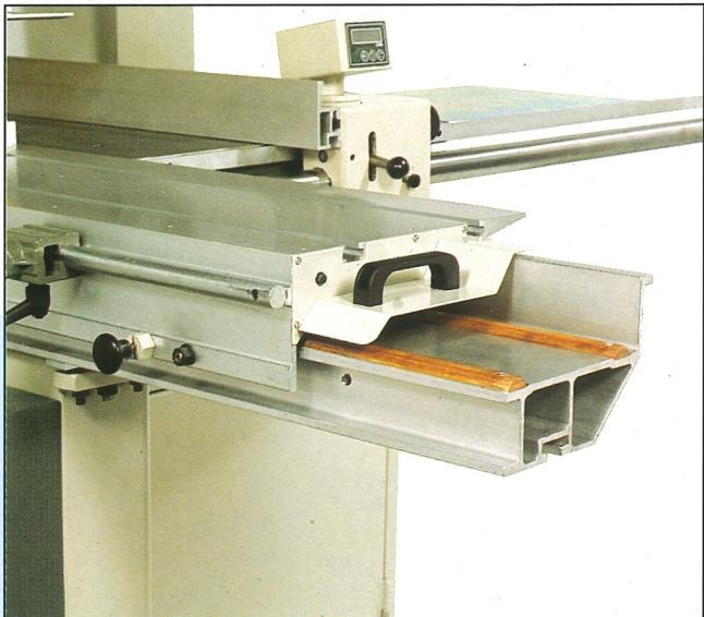
Il carrello, grazie alle sue grandi dimensioni ed al ridotto peso specifico assicura una grande precisione e scorrevolezza. Con la stessa precisione e facilità di scorrimento il carrello continua a funzionare nel tempo grazie alle guide su cui scorre, realizzate in "rexilon", materiale durissimo e refrattario alla polvere. Per i materiali più delicati il carrello e tutte le altre parti in alluminio sono anodizzate.
