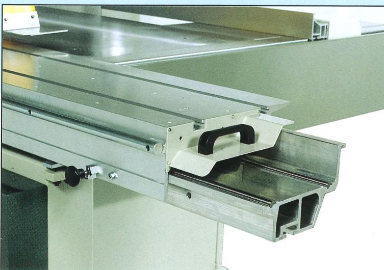
Tutti i modelli possono essere forniti a richiesta di carrello in lega con guide di scorrimento in acciaio temprato. Il sistema di scorrimento rimane quello collaudatissimo del modello base con carrucole e cuscinetti volventi su un asse orizzontale. Solamente in questo modo infatti è possibile garantire un ideale sostegno del carrello superiore mobile in tolleranze strettissime e con una scorrevolezza unica e durevole. Carrello con prestazioni tuttora ineguagliate.
