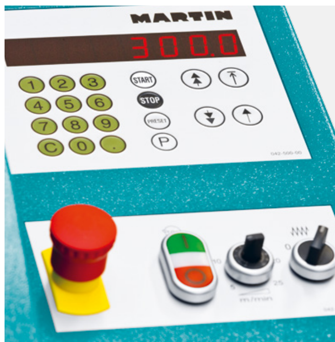
Réglage en continu 5 – 25 m/min
