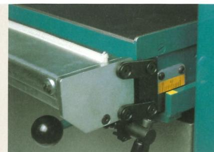
Automatische Gleitmittelzufuhr für den Dickentisch T4530
