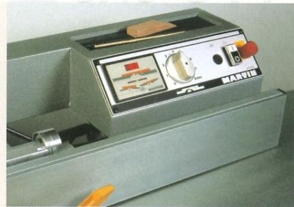
Bedienpult mit fahrendem Abrichtanschlag T544
