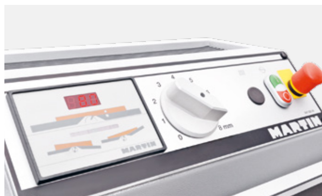
Quadro di comando combinato che si sposta insieme alla battuta di piallatura | T544
