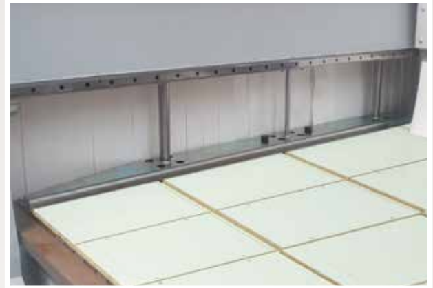
Dispositivo di ausilio allo scarico per l'espulsione dei particolari lavorati dal piano macchina pulizia dello stesso. (opt.) Dispositif d'aide au déchargement: permet l'expulsion des pièces usinées de la table de la machine tout en les nettoyant. (opt.) Hilfe-Entschickungsvorrichtung ermöglicht die Entnahme der bearbeiteten Teile vom Arbeitstisch. (opt.)
