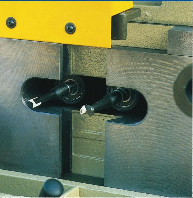
**4** Testa operatrice con gruppo cavatrice catena e aggregato, fraese verticali registrabili per eseguire contemporaneamente l'alloggiamento della serratura e la fresatura della piastrina.
