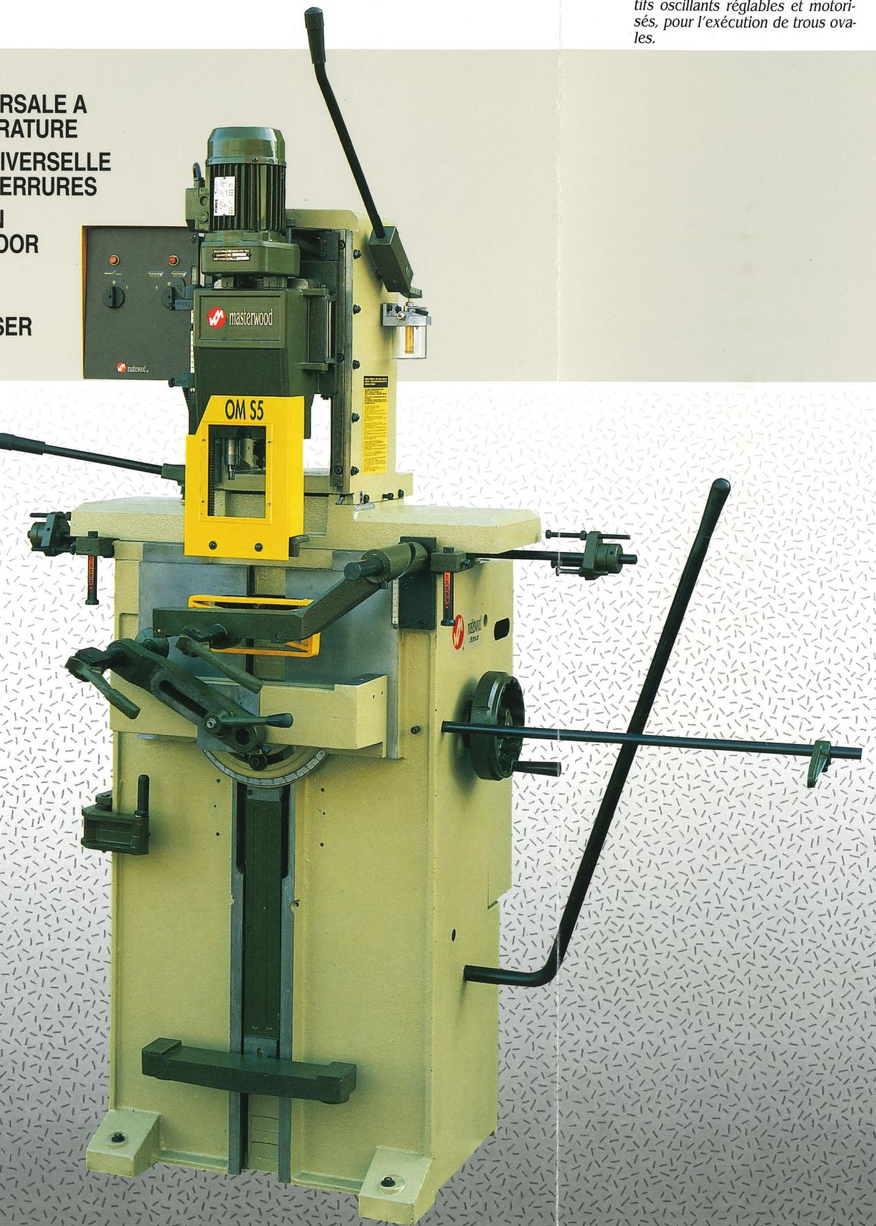
**1** Guide precaricate in acciaio temperato-cementato e rettificato con interposizione di gabbie e rullini che assicurano uno scorrimento verticale della testa operatrice dolce e preciso in completa assenza di giochi.
