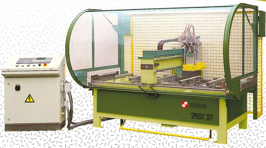
4 Una battuta anteriore (opzionale) completa di 4 cilindri di bloccaggio consente la foratura in piano e di coltello di strisce e pezzi stretti. Quattro lame (opzionali) a funzionamento pneumatico sollevano il pannello sul piano di lavoro.
