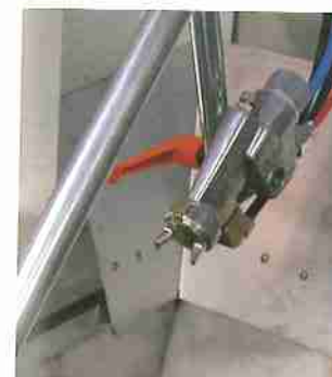
Set di pistole a BASSA PRESSIONE con elevata efficienza di trasferimento Set of LOW PRESSURE guns with high transfer coefficient Juego de pistolas de BAJA PRESIÓN con elevado coeficiente de traslado
