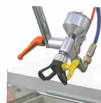
Set pistole AIRLESS alimentata da pompa alta pressione OPT Set of AIRLESS guns fed by high pressure pump (OPT) Juego de pistolas AIRLESS alimentadas por una bomba de alta presión (OPT)
