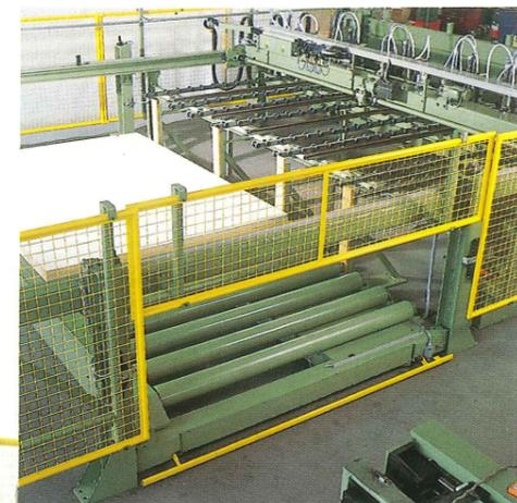
Hubtisch ausgelegt mit angetriebenen Schwerlastrollenbahnen. Die Plattenstapel können von links, rechts oder von hinten auf den Hubtisch aufgebracht werden.
