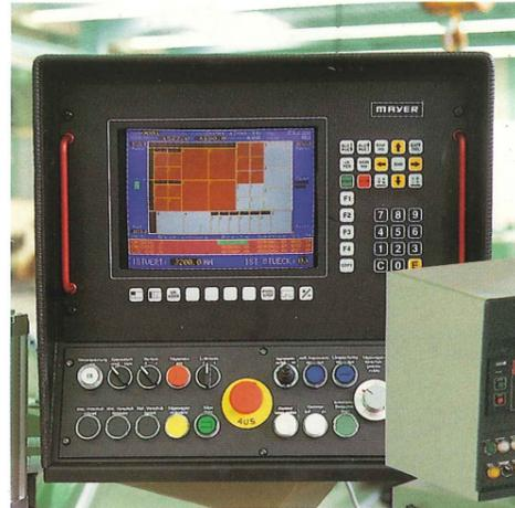
Steuerung PC 4000 mit Farbgrafikbildschirm, Bedienungsführung und Schnittfolgeanzeige.
