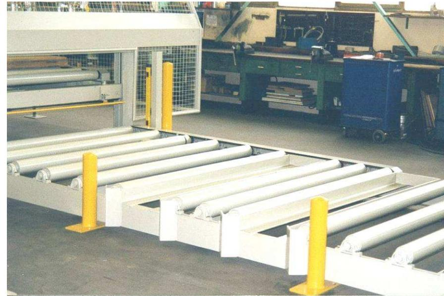
Angetriebene Schwerlastrollenbahn mit Gabelstaplertaschen
