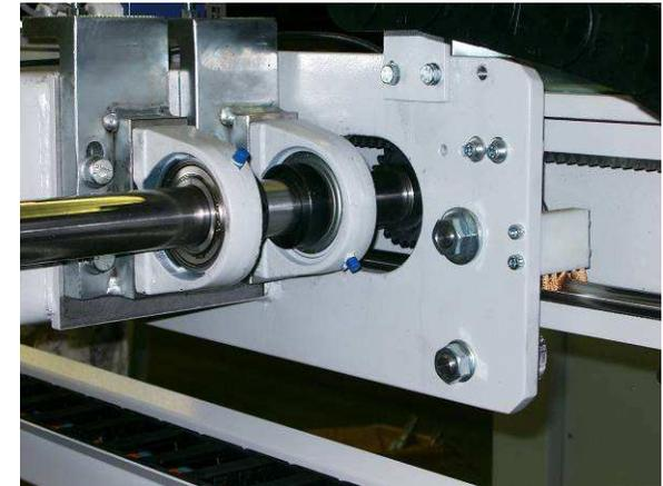
Anschlagtiefenverstellung für Materialschieber mit modernem AC-Servoantrieb
