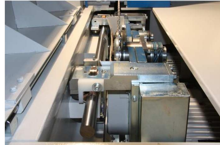
Sägewagen läuft auf Rundführungen mit 30 mm Durchmesser.
