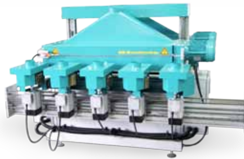
Sonderlösung mit zusätzlichen, seitlich verstellbaren Kantenbearbeitungsaggregaten
