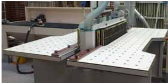
Twin Duplex mit zwei Schleifbereichen in einer Schleifinsel
