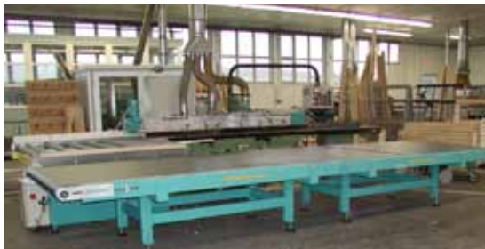
Automatisationslösung Profiturn S zum Umfälen von Flügelrahmen
