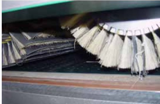
Doppelbürstenaggregat im Gleich- und Gegenlauf. Bestückung mit leicht austauschbaren Schleifsegmentbürsten
