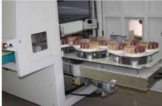
ROBA Profi Disk zum Schleifen von Rückseiten im Durchlauf
