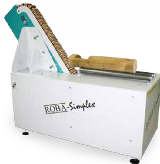
Sonderkonstruktion zur Bearbeitung von Rundhölzern
