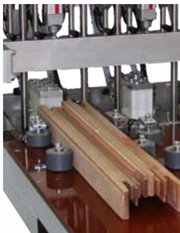
Zwei Werkstücke werden gleichzeitig belemt
