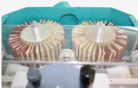
MB Flex Schleifkopf installiert in einer Doppelbürste
