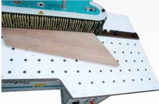
ROBA Duplex im Einsatz: Kantenschliff an Massivholztreppenstufen
