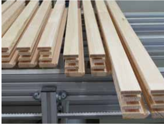
Fensterhölzer werden mit hoher Präzision ausgerichtet
