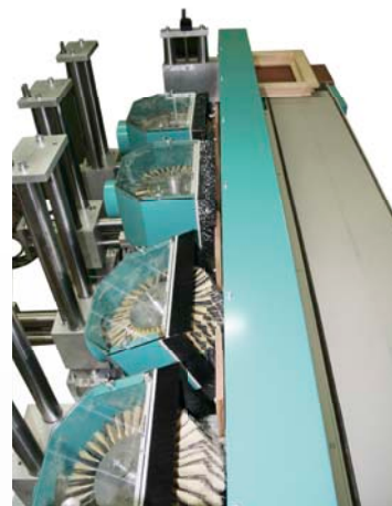
Vier Aggregate, die im Gleich- und Gegenlauf arbeiten, garantieren perfekte Ergebnisse
