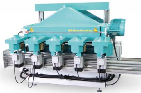
Sonderlösung mit zusätzlichen, seitlich verstellbaren Kantenbearbeitungsaggregaten
