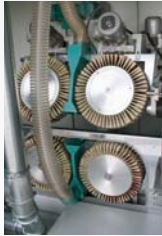
Programmgesteuerte Schwenkachse bringt das obere Schleifaggregat in Position.
