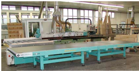
Automatisationslösung Profiturn S zum Umfälen von Flügelrahmen
