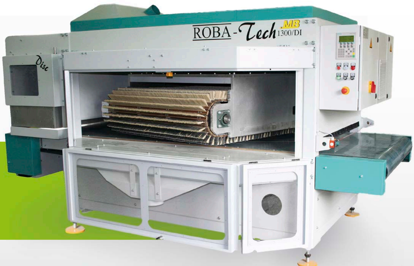
ROBA Tech Vertikal zum Schleifen von Türen, die in einem Fördersystem hängen
