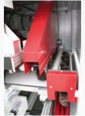
Das Querreinigungsaggregat, optional auch von unten. Ausgeführt wahlweise als Rundbürste oder Querreinigungsband
