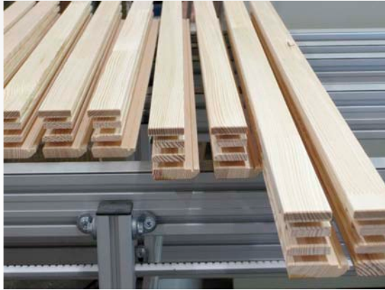
Fensterhölzer werden mit hoher Präzision ausgerichtet
