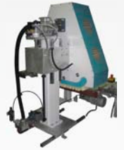
RB300 Aggregat mit motorischer Höhenverstellung und Oszillationseinheit
