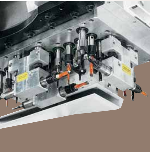
Groupe de perçage 18 mandrins verticaux et 6 mandrins horizontaux.
