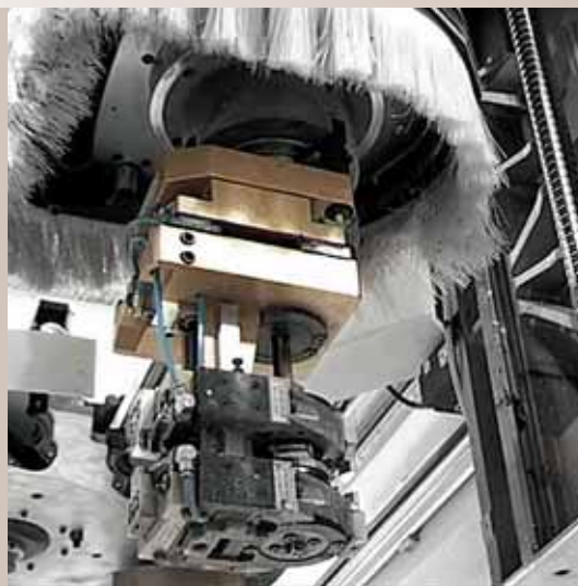
Électromandrin de 13 kW 4 ou 5 axe de nouvelle génération (en modalité d'usinage S1) pour réaliser toutes les usinages avec la plus haute précision et qualité de finition du chant. Grande disponibilité d'outils grâce à 28 positions dans le magasin.
