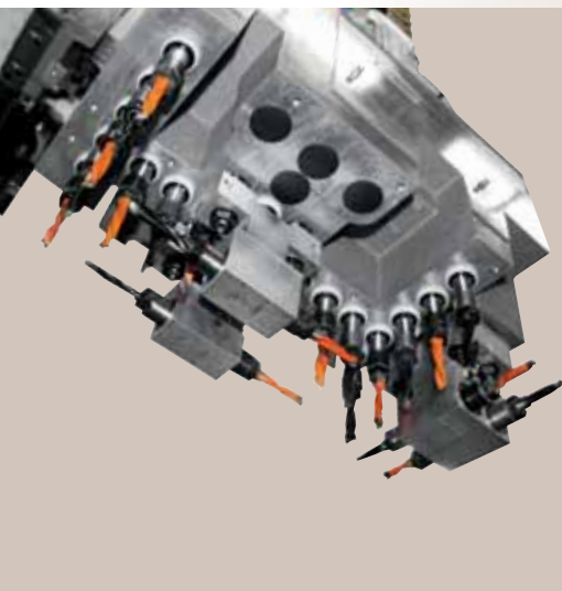
Tête de perçage avec 26 mandrins. Pour répondre efficacement aux exigences les plus élémentaires de perçage.
