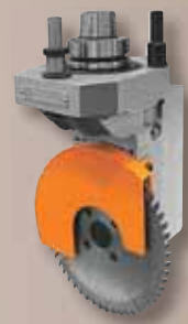
Groupe lame pour le coup en bout et pour l'exécution des coupes à angles
