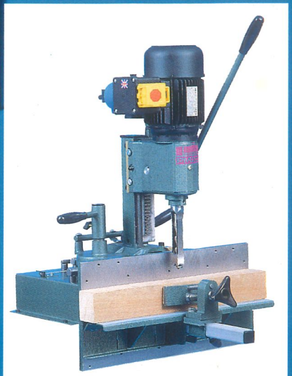
Das Tischmodell PM20 mit zusätzlicher Präzision der x-y Bewegung.
