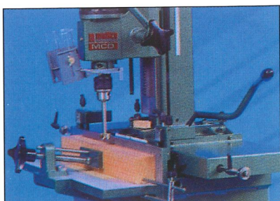
Schneller Umbau in eine Bohrmaschine. MULTICO-Stemmaschinen können bei Bedarf jederzeit als Langloch-Bohrmaschine eingesetzt werden.
