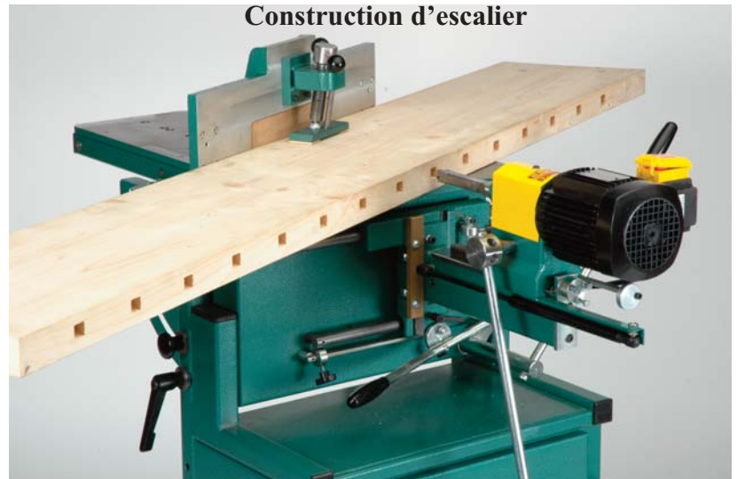
Machine qui nous permet la mortaise et le perçage de longues pièces de bois
