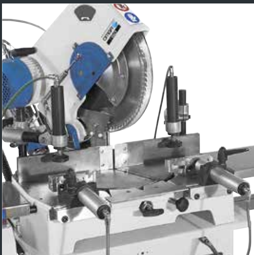
Morzada horizontal neumática (T50 - T 53) Prensor vertical neumático (T50 - T 53)
