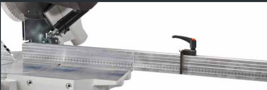
Prolongación de guía + tope manual (Modelos diferentes para 1P350F - 1L300F)
