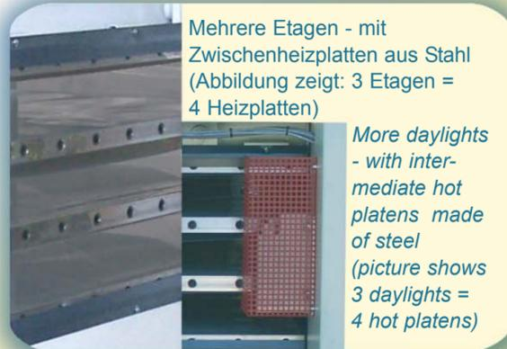
Mehrere Etagen - mit Zwischenheizplatten aus Stahl (Abbildung zeigt: 3 Etagen = 4 Heizplatten)
