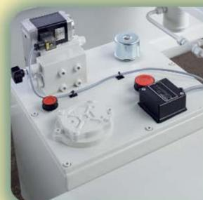
Hydraulikaggregat als Kompakteinheit, mit wartungsfrei im Ölbad laufenden Elementen
