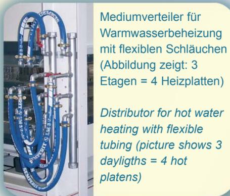
Mediumverteiler für Warmwasserbeheizung mit flexiblen Schläuchen (Abbildung zeigt: 3 Etagen = 4 Heizplatten)
