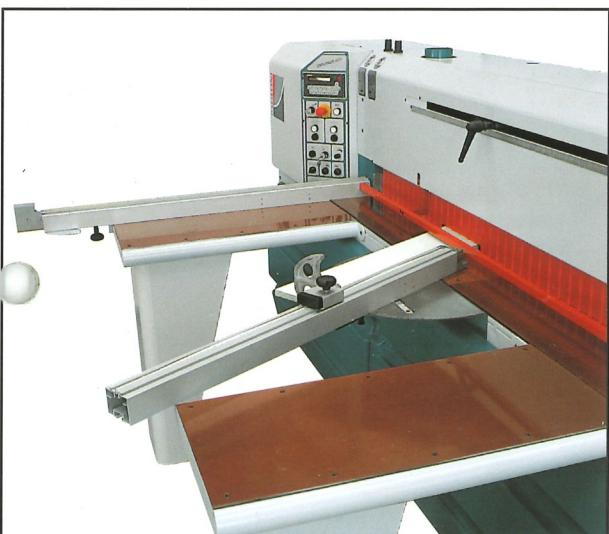
**Dispositivo de corte angular (+/-45°).** Extremamente útil quando for necessário realizar cortes frequentes com vários ângulos. O dispositivo está equipado com esquadro e batente com marcas de referência fixas a cada 5° e 22° 30'.
