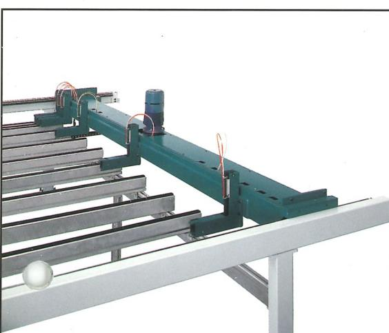
**O empurador, com ou sem pinças,** comandado por inverter, desliza em guias cilíndricas com rodas auto-alinhadoras moldadas e planas. As pinças, muito robustas, seguram o conjunto de painéis a serrar, garantindo um corte extremamente preciso.
