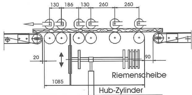
Einstellung der Längenschnitze entsprechend der max. Schnitthöhe sowie der min. und max. Schnittbreite
