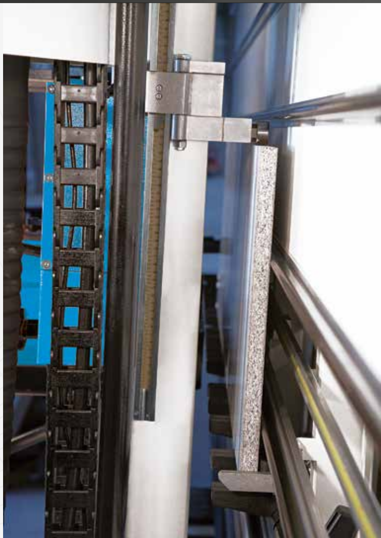
Dispositivo taglio strisce orizzontali. Repeat cutting device of horizontal strips. Dispositivo corte tiras horizontals. Dispositif coupes de bandes repetitive en horizontale.
