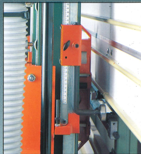
Dispositivo taglio a strisce orizzontali (optional). Corte tiras horizontales (optional). Dispositif pour coupes horizontales répétitives (optional).
