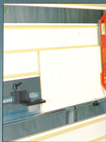
Dispositivo ribaltabile per taglio pezzi corti. Dispositivo giratorio para cortar piezas pequeñas. Rail rabattable pour petits panneaux.
