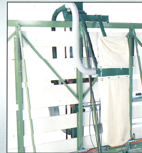
Sistema d'aspirazione incorporato. Sistema aspiracion virutas incorporado. Dispositif d'aspiration de sciures incorporée.
