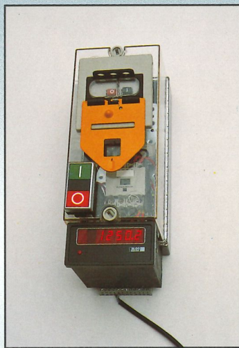
Pulsantiera con visualizzatore elettronico quote orizzontali (optional) / Teclado de mando con sistema de medición electrónico por los cortes horizontales (optional) / Tableau de commande avec lecture digitale électronique pour les découpes horizontales (optional).
