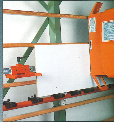
Dispositivo ribaltabile per taglio pezzi corti. Dispositivo giratorio para cortar piezas pequeñas. Rail rabattabile pour petits panneaux.
