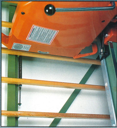
Piano spostabile automatico. Deslizamiento automatico del plano de apoyo. Châssis escamontable automatique.
