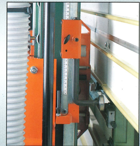
Dispositivo taglio a strisce orizzontali (optional). Corte tiras horizontales (optional). Dispositif pour coupes horizontales répétitives (optional).
