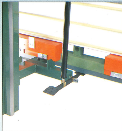
Pedale di bloccaggio del montante al telaio. Pedal para el bloqueo de la bancada a la estructura. Pédale pour le blocage de la poutre au châssis.
