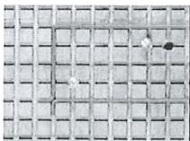
Der feststehende Maschinentisch hat eine Vakuum-Rasterplatte aus einer 30 mm starken und gerasterten (30 mm x 30 mm) Kunstharzpressholzauflage.
