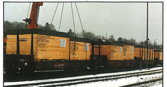
Bahnverladung von überbreiten Maschinenteilen
