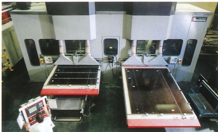
ECO im Einsatz bei den Elbe Flugzeugwerken GmbH (Airbus). Flugzeug-Ausrüstungskomponenten, wie Sandwichplatten aus GFK- und CFK Deckschichten sowie Kunstharz- und Aluminiumwaben als Kernmaterial werden hier im 3-Schicht-Betrieb mit der erforderlichen reproduzierbaren Qualität bearbeitet.
