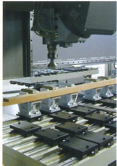
Der variable Einsatz von Spannvorrichtungen und Aggregaten ermöglicht es, die ECO an alle Fertigungsbedürfnisse anzupassen. Ein kardanisches Bearbeitungsaggregat (5-Achs-Kopf) auf separat verfahrbaren Aggregateschlitten sowie bauteilspezifische Spannkomponenten zeigen die Funktionsvielfalt.
