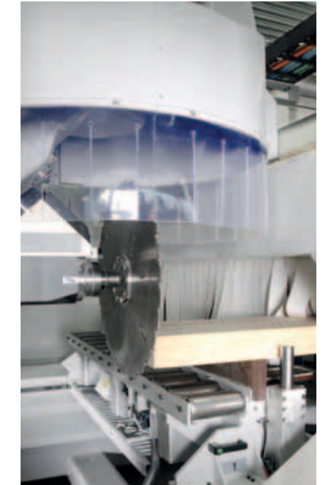
Leimbinder-Bearbeitung (bis 50 m) mit einem 5-Achs-Arbeitsaggregat (Spindel 55 kW, Sägeblatt 800 mm).
