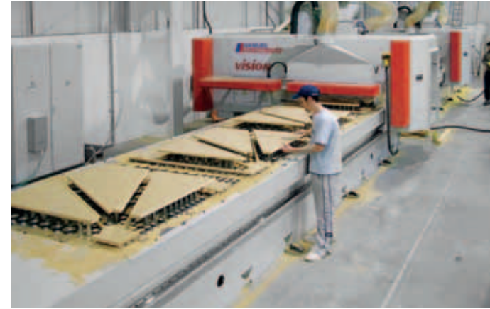
VISION mit Pintisch: In 12 Minuten (einschließlich Rüsten) werden 12 Eckstufen bearbeitet.
