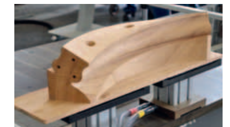
Interpolierende 5-Achs-Bearbeitung. Handlauf wird komplett bearbeitet und abgetrennt. Konstruktions- und Programmierung über Softwarehersteller.
