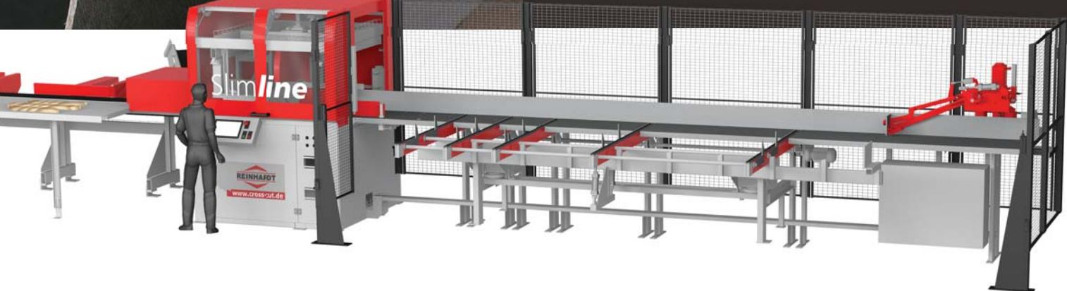
Das Sägeaggregat der SL 225 W ist +/- 60° verstellbar. Die Winkelschnitteinrichtung von 30° bis +150° erfolgt vollautomatisch. Über die Steuerung können jedem Abschnitt 2 unterschiedliche Schnittwinkel vorgegeben werden, die in Kombination mit einem 90° Schnitt bis zu 3 Winkelschnitte je Seite ermöglichen.
