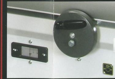
In twee richtingen schuininstelbare aanslag (0° - 45°), voorzien van een snelspanhoutklem en wegklapbare aanslag.
