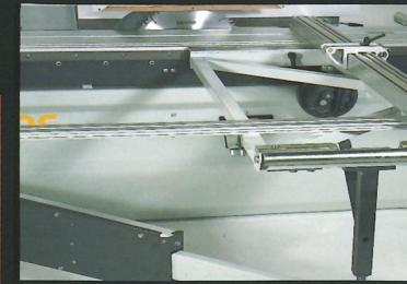
Laterale steuntafel, telescopisch ondersteund en voorzien van een uitschuifbare aanslagbalk met 2 stevige wegklapbare aanslagen. De aanslagbalk kan zowel voor- als achteraan op de steuntafel geplaatst worden.
