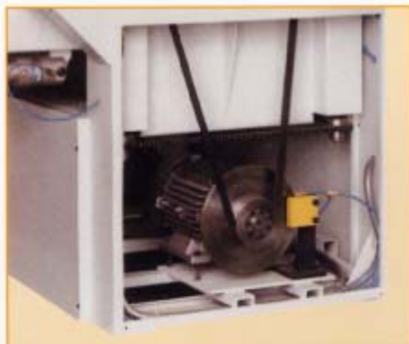
Centraggio automatico tappeto Automatic centring of the feed mat Automatische Teppichzentrierung Centrage automatique du tapis Centrado automático del tapete Centragem automática do tapete
