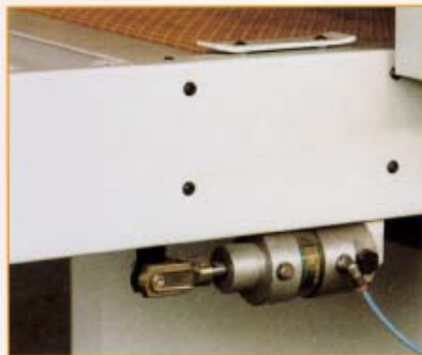
Centraggio automatico tappeto Automatic centring of the feed mat Automatische Teppichzentrierung Centrage automatique du tapis Centrado automático del tapete Centragem automática do tapete
