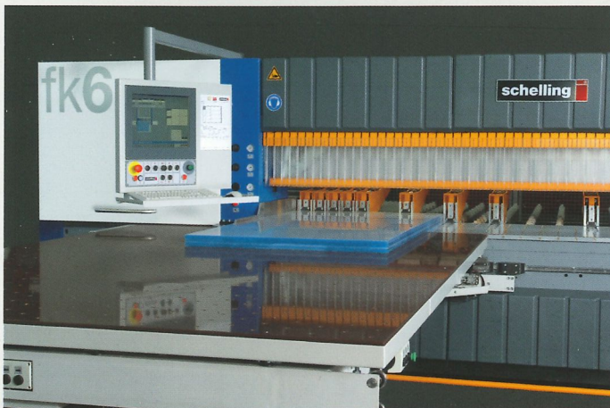
Drehtisch verschiebbar - einfaches Arbeiten am Winkelanschlag
