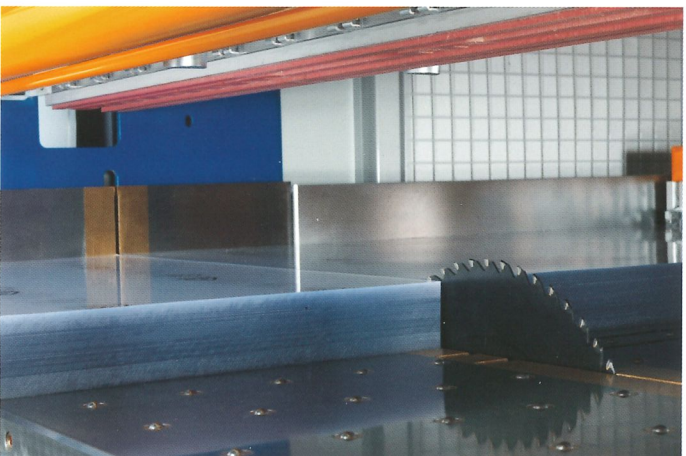
Maschinentisch mit Luftdüsen - beste Oberflächenschonung
