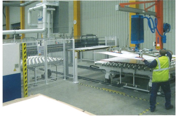
Vorbereitungstisch - gleichzeitiges Beschicken und Aufteilen der Platten
