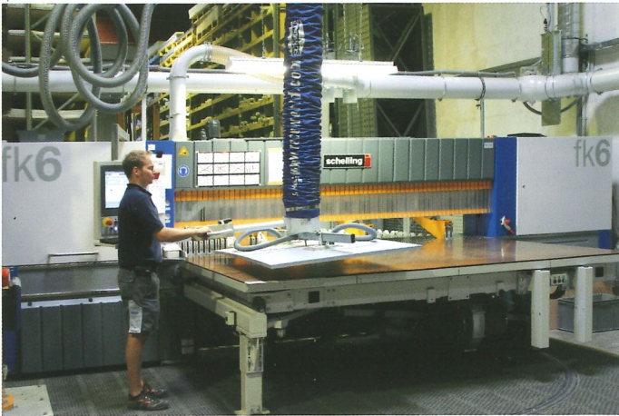
Beschickung mit Schwenkkran und Vakuumsauger – einfachstes Handling von Platten
