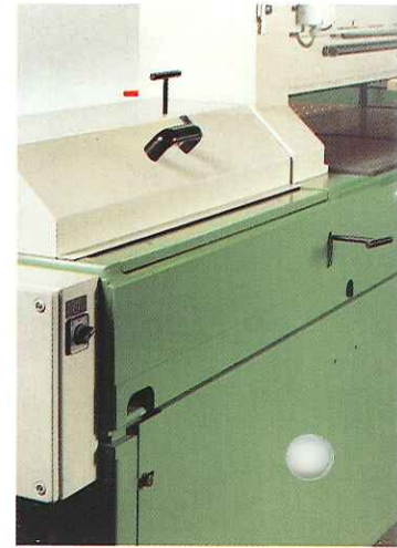
Abb. oben manuelle Ritzver- stellung von außen
