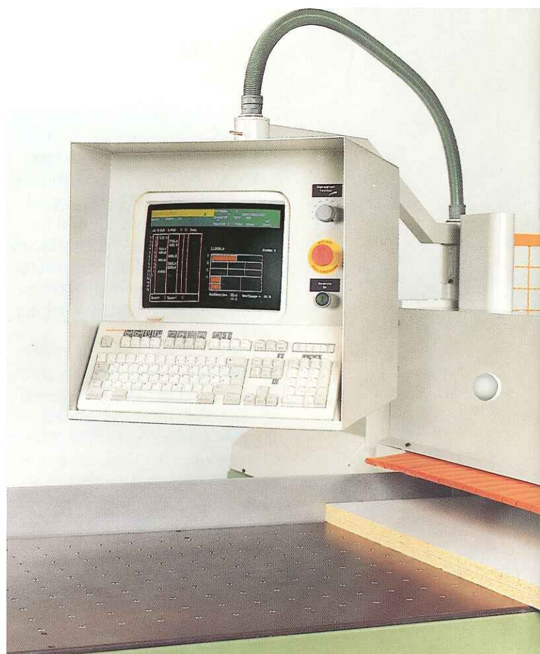
Schwenkpaneel mit 14" VGA-Farbmonitor und Multifunktions-tastatur
