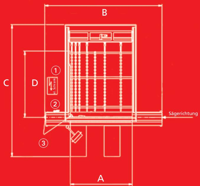
① Elektrischer Anschluß ② Luftanschluß ③ Absaugung
