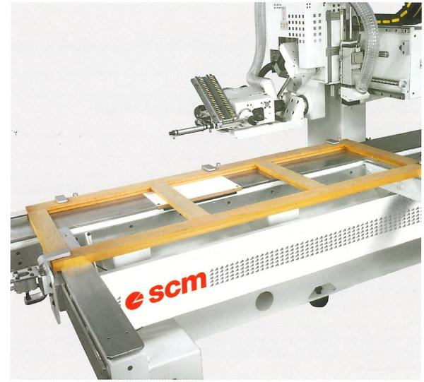
Equipement pour l'usinage de la fenêtre ou de la porte assemblée.
