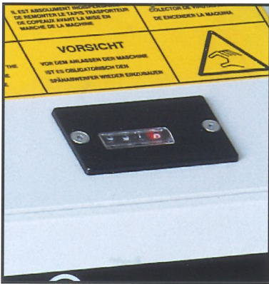
Visualizzatore di quota Digital thickness display Digitalanzeiger der Arbeitsstärke Affichage électronique d'épaisseur Visualizador de cuota
