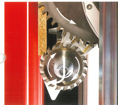
Präzise Schnittkanten unterschiedlichster Form mit flexibler Vorritzsäge
