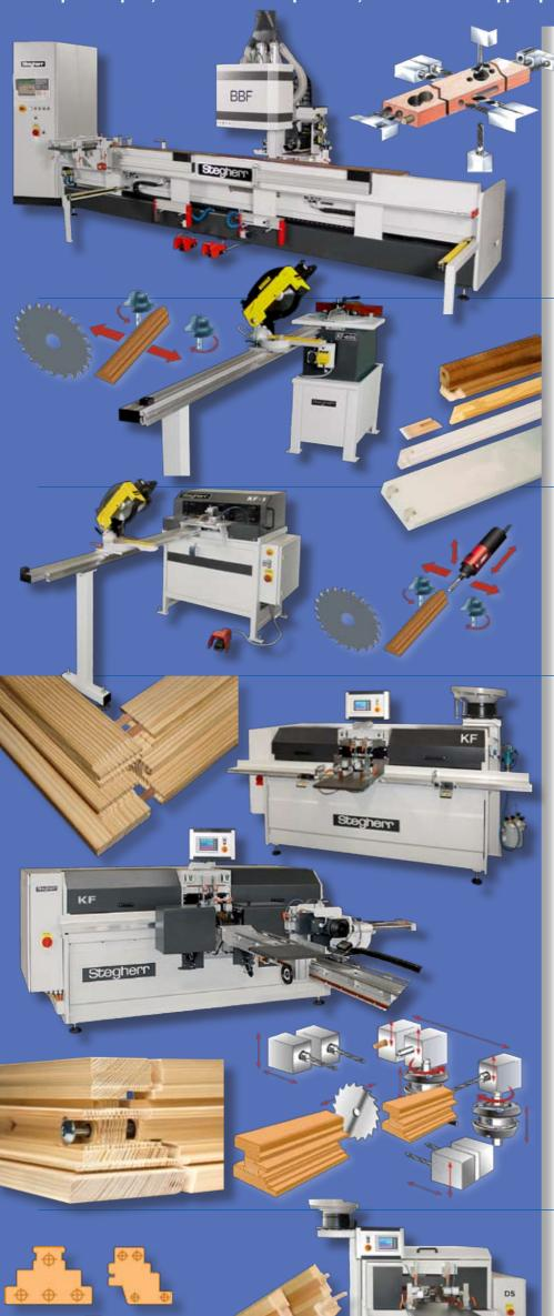
Centre d'usinage à CN pour le perçage, fraisage et tourillonnage dans la fabrication de portes et fenêtres
