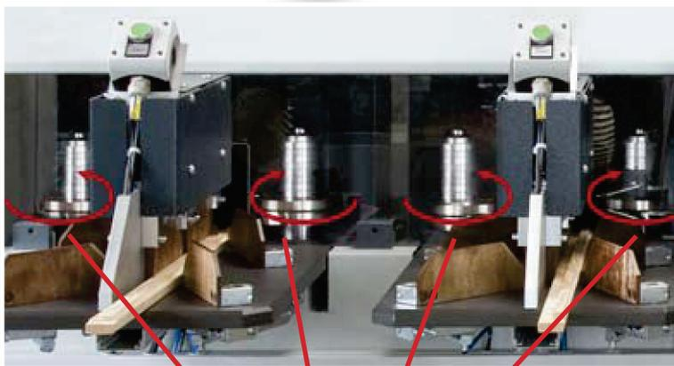
Vier Frässpindeln für erhöhten Durchsatz
