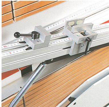
Die Werkstück- Kantenlänge ist mittels Anschlag und integrierter Massskala einstellbar. Platten bis zur Stärke von 42mm (COMPACT 25 mm) werden von den Schraubklemmen schonend fixiert.
