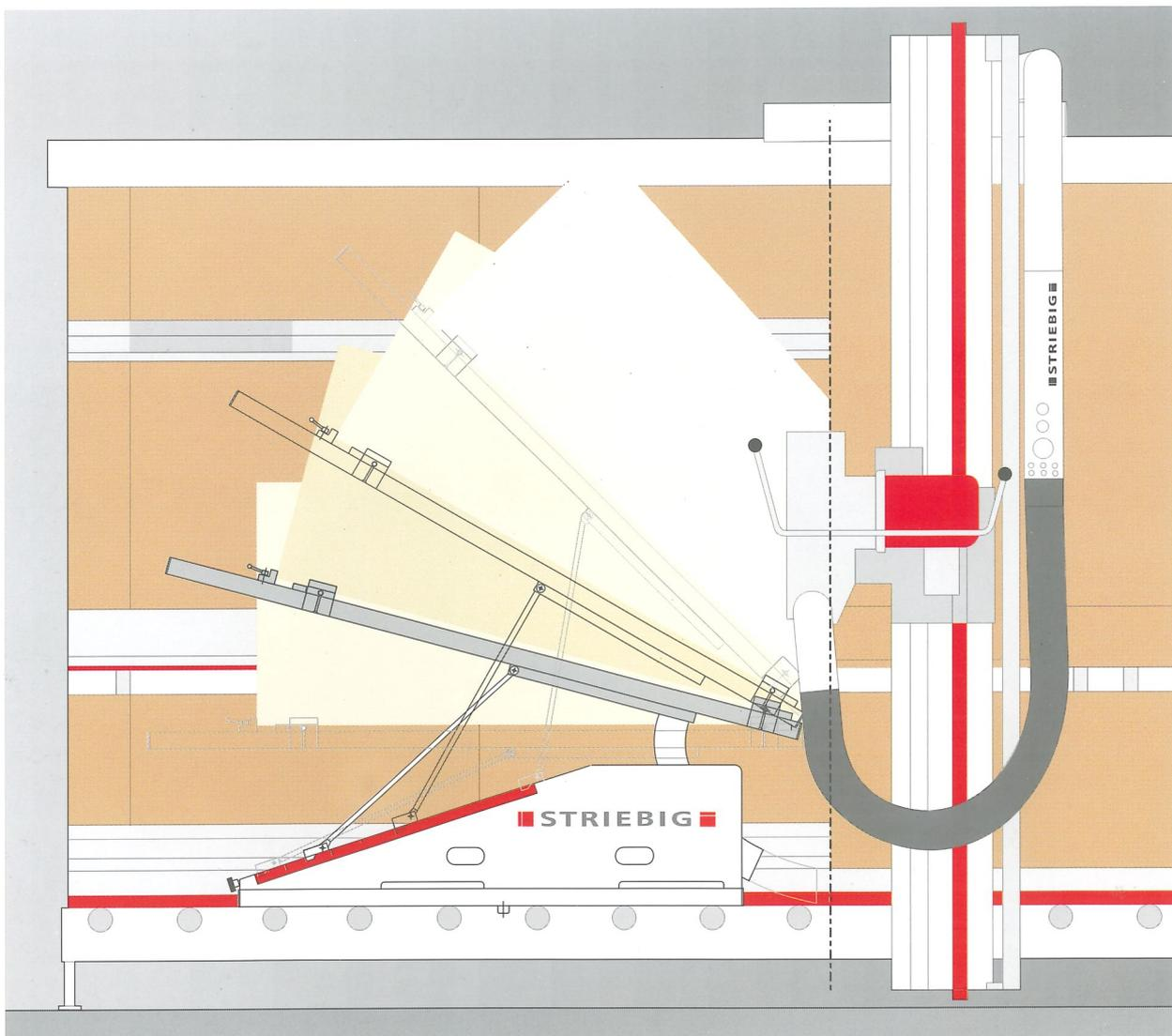
Die Werkstückauflage des Winkelschnittgerätes dreht in einem Kreis, dessen Mittelpunkt auf der Schnittlinie liegt. Das eingestellte Mass bleibt in jeder Einstellung erhalten.
