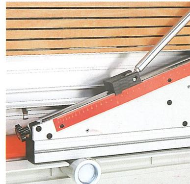
Grob- und Feineinstellung mittels Rastersystem bzw. Sterngriff, auch unter Last für Winkel von 0 bis 46° auf 0.1° genau einstellbar.
