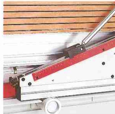
Grob- und Feineinstellung mittels Raster-system bzw. Sterngriff, auch unter Last für Winkel von 0 bis 46° auf 0.1° genau einstellbar.
