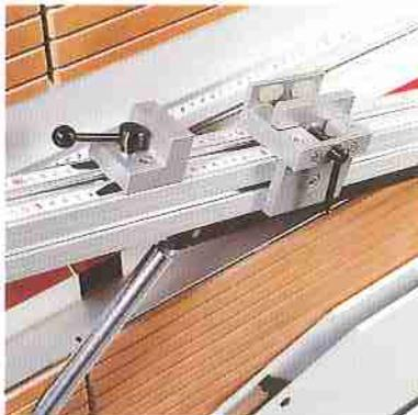
Die Werkstück-Kantenlänge ist mittels Anschlag und integrierter Massskala einstellbar. Platten bis zur Stärke von 42 mm werden von den Schraubklemmen schonend fixiert.
