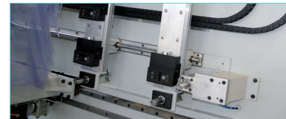
Battute a scomparsa Stops Anschläge Butées escamotables Topes escondidos
