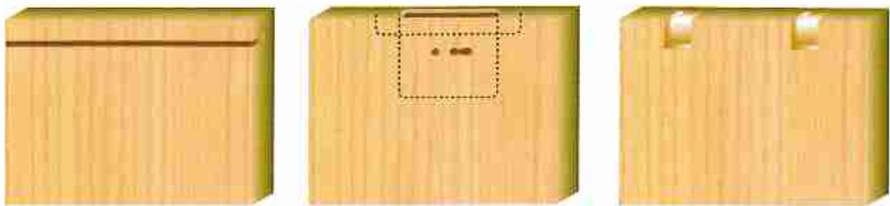
Fresature longitudinali per incastro pannello posteriore Longitudinal grooving to insert the rear panel Nutfräsung für Rückwand
