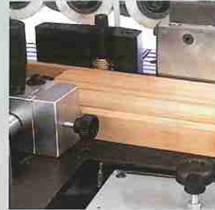
Carga con rodillo de agujas o rodillo de goma para cantos finos con regulación del empuje mecánico.
