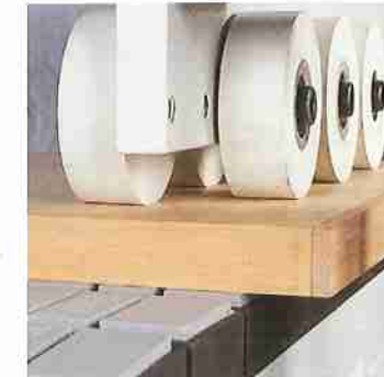
Doble fila de ruedas de presión descentradas.
