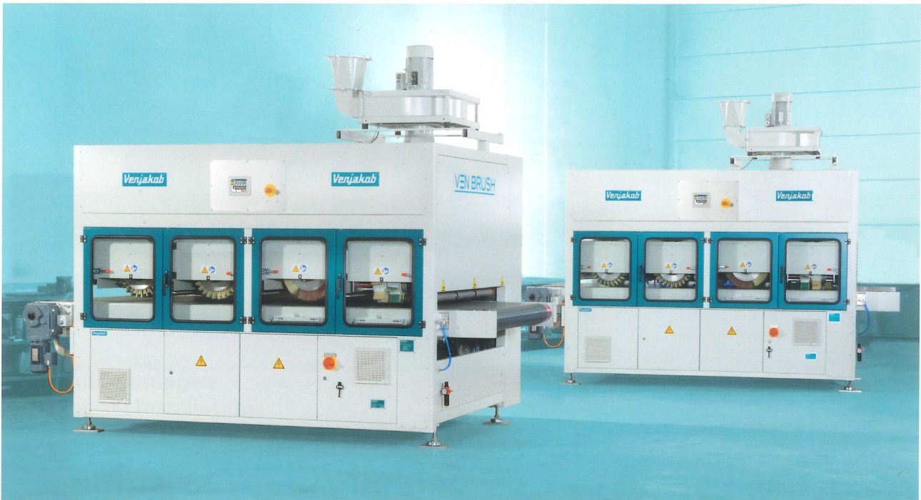
VEN BRUSH VBS 1300-40 mit 1 Querschleifaggregat und 3 feststehenden Rundbürsten VEN BRUSH VBS 1300-40 with 1 cross sanding unit and 3 fixed circular brushes
