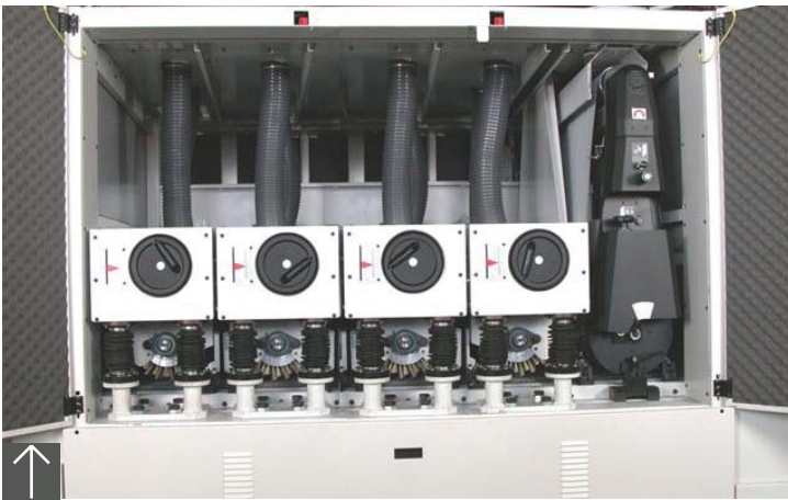
GRUPPO RULLO 320 mm + N. 4 GRUPPI SPAZZOLE ABRASIVE SANDING DRUM 320 mm + N. 4 ABRASIVE BRUSHING UNITS
