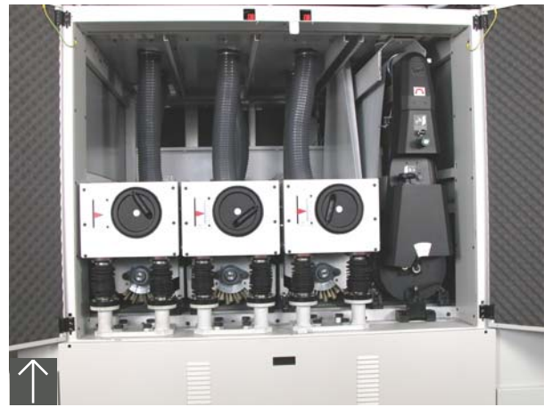
GRUPPO RULLO 320 mm + N. 3 GRUPPI SPAZZOLE ABRASIVE SANDING DRUM 320 mm + N. 3 ABRASIVE BRUSHING UNITS
