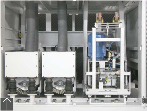
GRUPPO SPIN BRUSH + N. 2 GRUPPI SPAZZOLE ABRASIVE SPIN BRUSH UNIT + N. 2 ABRASIVE BRUSHING UNITS
