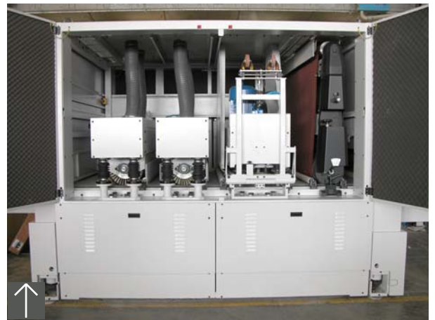
GRUPPO RULLO 240 mm + GRUPPO SPIN BRUSH + N. 2 GRUPPI SPAZZOLE ABRASIVE SANDING DRUM 240 mm + SPIN BRUSH UNIT + N. 2 ABRASIVE BRUSHING UNITS
