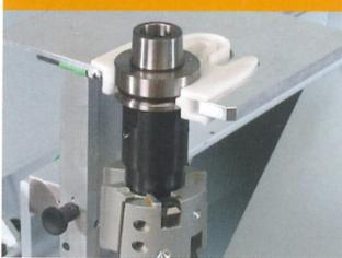
Sicheres und schnelles Beschicken des Werkzeugwechsellmagazines
