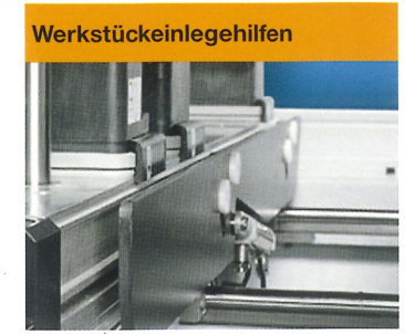
4 robuste Einlegehilfen zum Belegen schwerer Werkstücke
